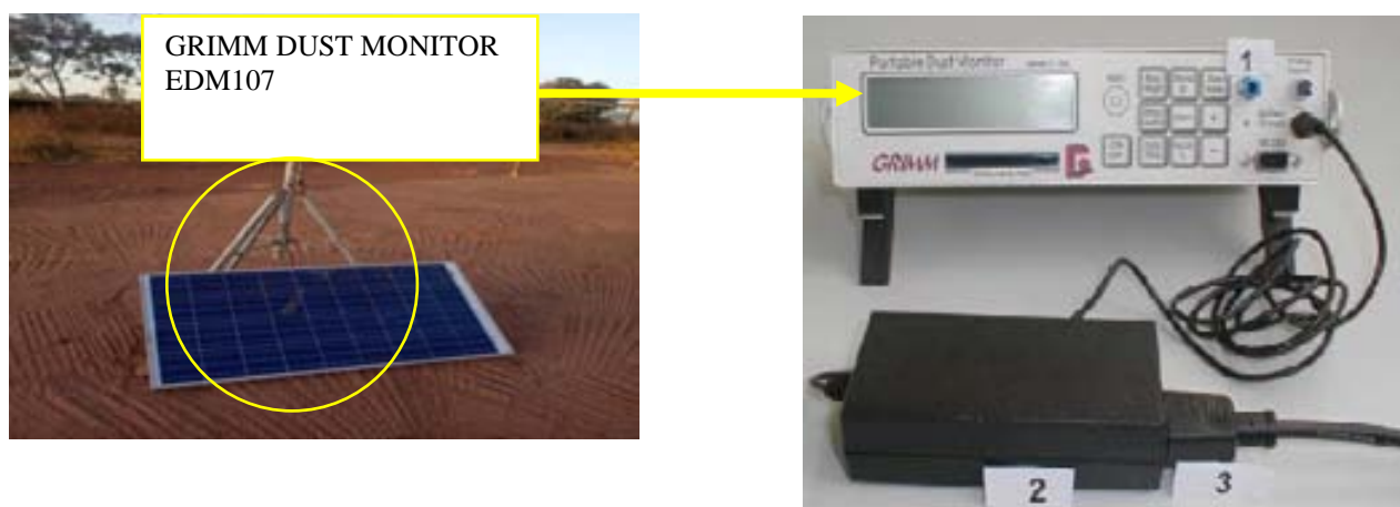
L'appareil utilisé pour la mesure simultanée des TSP PM10 et des PM2,5 est le GRIMM DUST MONITOR EDM107 dont un filtre PTFE en téflon (47x0,1 mm) y est intégré.
